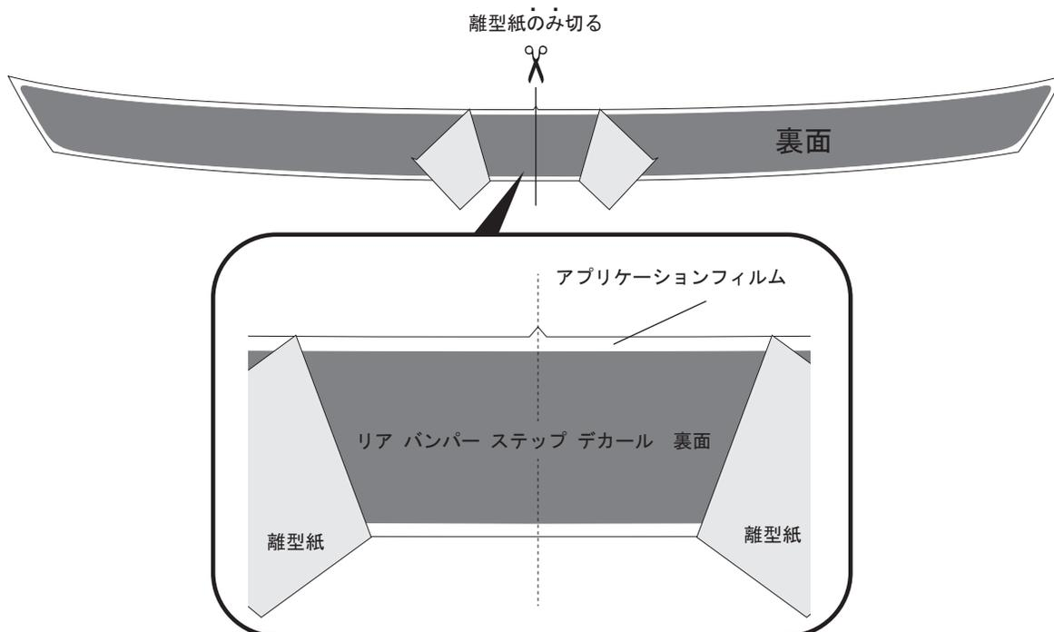
3. トランクのストライカー延長線上にリア バンパー ステップ デカールの中心を合わせ、リア バンパー後端のR止まりにアプリケーションフィルムの端を合わせる。
