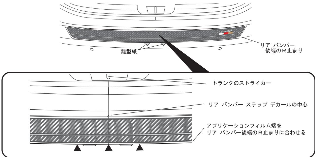
4. 折り曲げた離型紙を左右に引き抜くように剥がし、圧着する。この時、左右の位置合わせに注意しながら貼り付ける。
